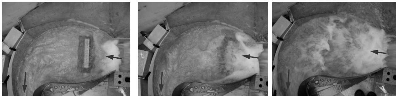
Figure 10 : Conditions d'écoulement dans la configuration finale du bassin de dissipation d'énergie, pour un débit de 20 \text{ m}^3/\text{s} (à gauche), de 40 \text{ m}^3/\text{s} (au milieu) et le débit de 80 \text{ m}^3/\text{s} évacué à PHE (à droite).
