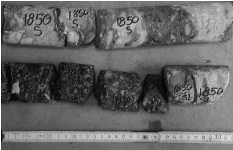
Abbildung 3: Bohrkerne bei Laufmeter 1850 ( f_c=14.8 \text{ N/mm}^2 , Sulfatgehalt 1.79 Massenprozent, Quelle: ewz)
