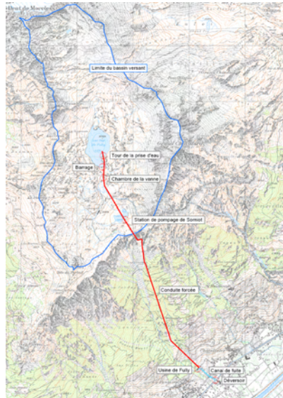
Figure 1 : Situation des ouvrages et du bassin versant de l'aménagement hydroélectrique de Fully
