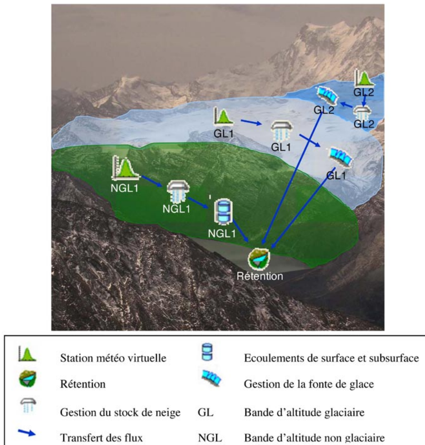
Figure 2 : Modélisation hydrologique fonctionnelle selon le concept Routing System à l'exemple du sous-bassin versant de Mattmark, avec découpage en bandes d'altitude des zones glaciaires et neigeuses
