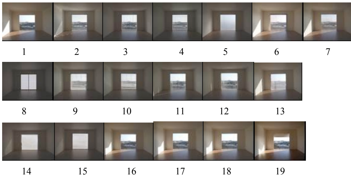
Figure 2: Photographs of 19 types of devices; 1) None 2) Horizontal louver 3) Vertical louver 4) Lattice louver 5) Glass block 6) Bamboo screen (interior) 7) Bamboo screen (exterior) 8) Shoji or paper-sliding door 9) Horizontal blind (interior) 10) Horizontal blind (exterior) 11) Vertical blind (interior) 12) Vertical blind (exterior) 13) Lace curtain 14) Roll screen (interior) 15) Roll screen (exterior) 16) Horizontal eave 17) Vertical eave 18) Eaves 19) Awning
