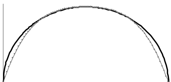
Figure 7.12 : Approximation polynomiale du tracé d'intrados de l'arc à l'axe. Le tracé original est figuré par un trait épais, tandis que le tracé approximé est représenté par un trait fin, surmonté de petits carrés.
