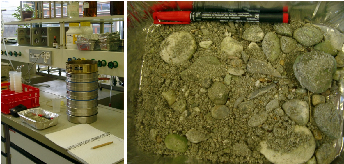
Figure 12 Distribution granulométrique des particules du fond du canal Sion-Riddes
