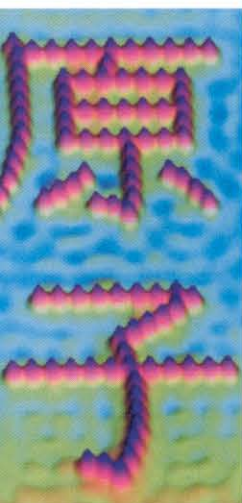
Abb. 1. Direkte Manipulation von Atomen auf einer Oberfläche mittels einer RTM-Spitze. Das Beispiel zeigt das Kanji-Symbol für „Atom“. Es besteht aus 100 Eisenatomen auf einer Cu(111)-Oberfläche bei einer Temperatur von 4 K. (Die Abbildung wurde freundlicherweise von D. Eigler zur Verfügung gestellt).
