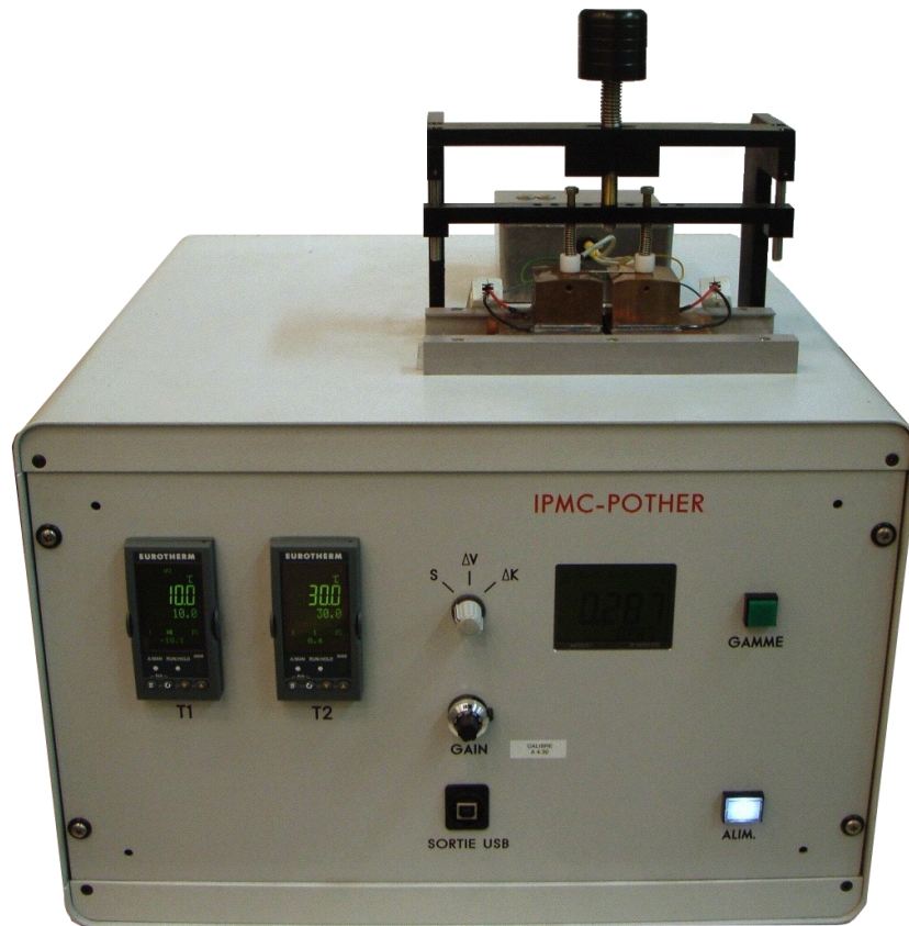
Figure 2.22 Appareil de mesure du pouvoir thermoélectrique. L'échantillon est maintenu sur des blocs de cuivre dont la température est régulée à 10°C et 30°C par des éléments Peltier. Les températures des contacts sont mesurées par des thermocouples séparés.
