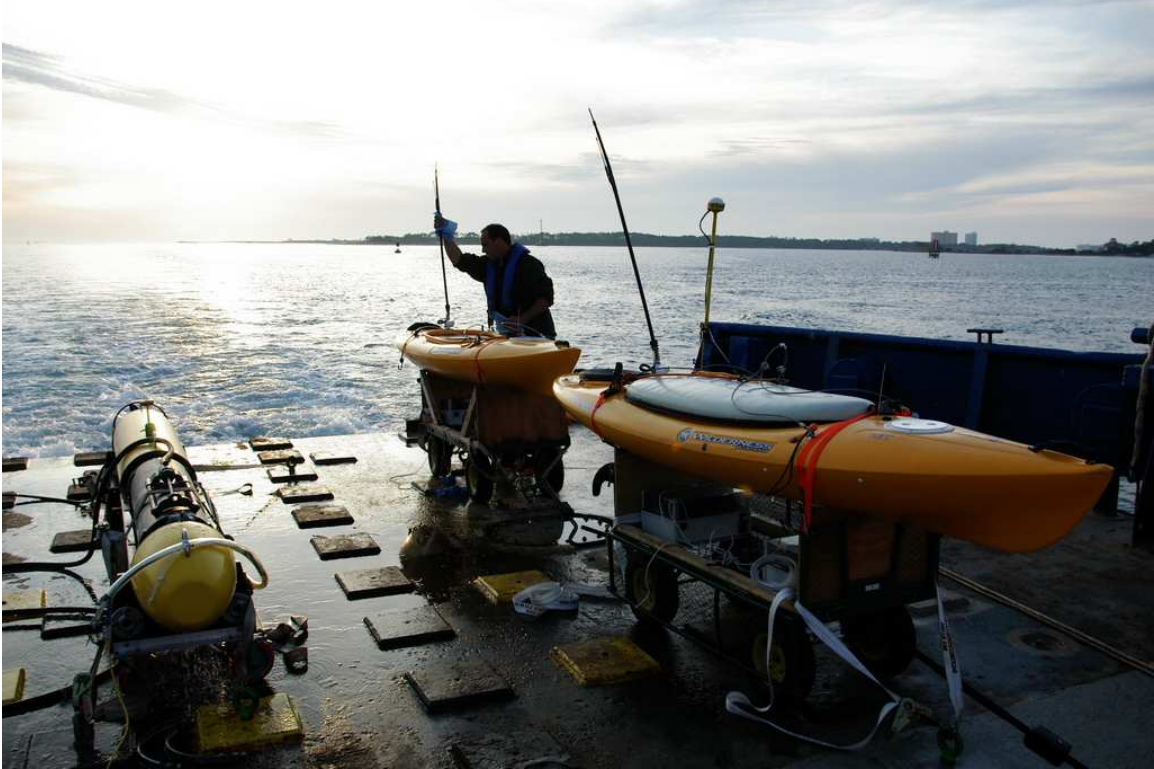
Figure 5-7: Two MIT ASCs and one Bluefin 12'' AUV.
