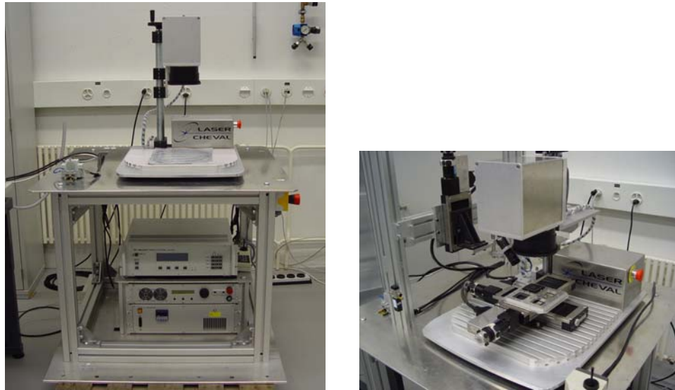
Fig. 3.3: Equipement laser utilisé dans le cadre de la thèse (diode laser + optique de déviation).
