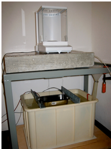
Figure 4.20 : Dispositif expérimental de mesure des variations volumiques.
