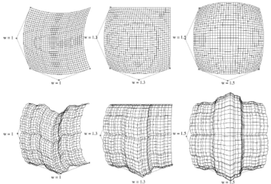
Durch unterschiedliche Gewichtung der Kontrollpunkte lassen sich die Flächen frei verformen.
