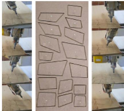
Computergesteuerte Fertigung der Plattenbauteile.
