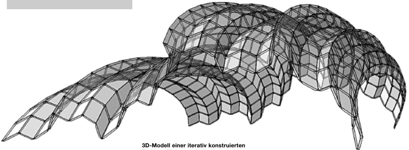
**3D-Modell einer iterativ konstruierten Freiformfläche aus Holzplatten.**
