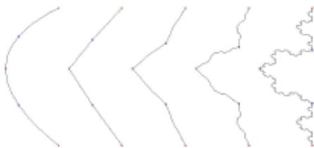
IFS-Kurve: Durch Verschieben der Subdivisionspunkte entsteht entweder eine glatte Bézierkurve oder eine fraktale Koch-Kurve.
