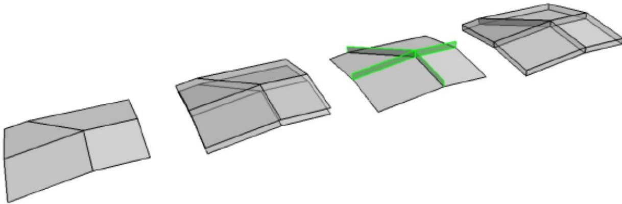
Ableitung der auf Gehrung geschnittenen Plattenbauteile.
