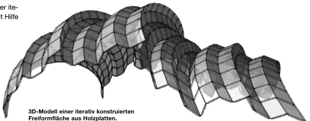
3D-Modell einer iterativ konstruierten Freiformfläche aus Holzplatten.
