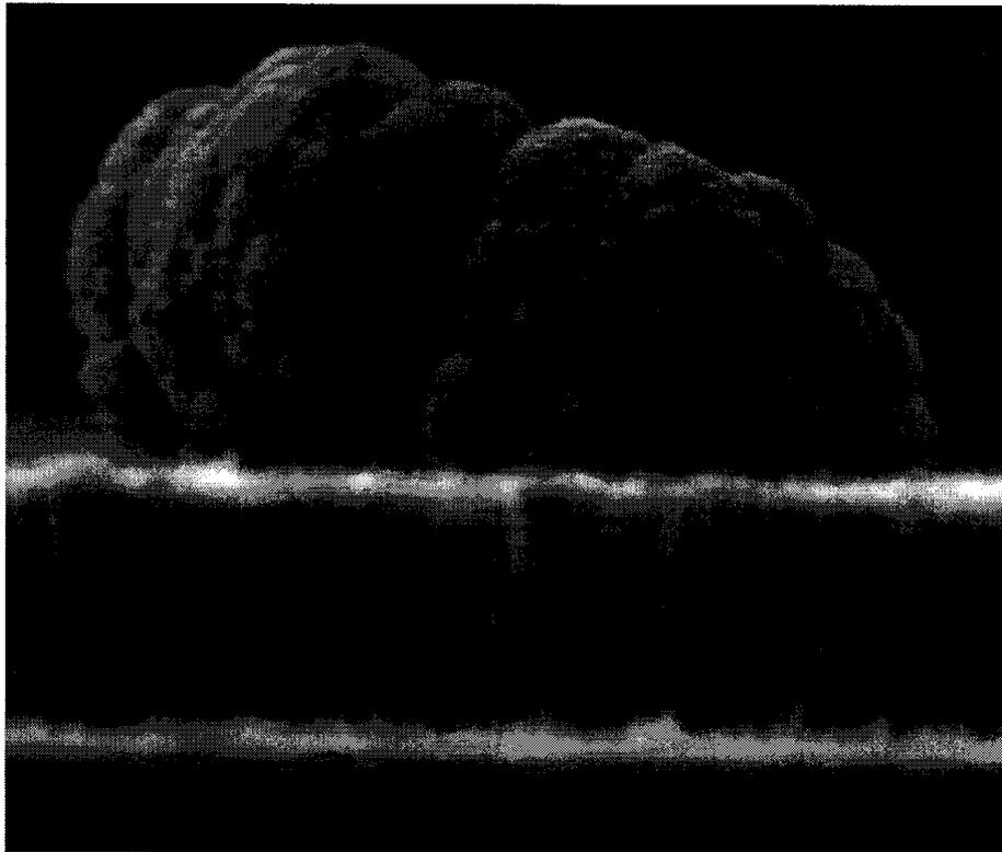
Image MEB d'une poudre de silicium déposé sur une couche de 1.5 microns  $\mu\text{-Si:H}$ .
