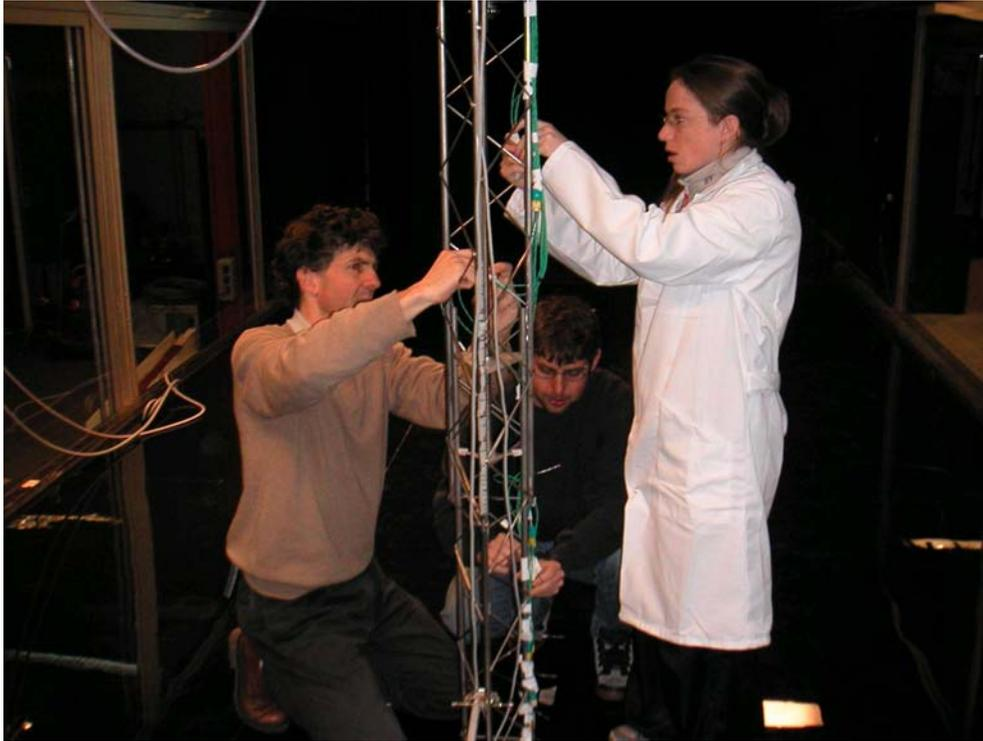
*Figure C-5: Photographie prise lors de la mise en place des capteurs de température. Ceux-ci permettent de vérifier la stabilité de la température au cours de la semaine de mesures.*
