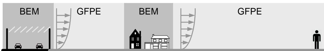
Figure 3-35: Exemple de configuration complexe pouvant être étudiée à l'aide de la GFPE-BEM.
