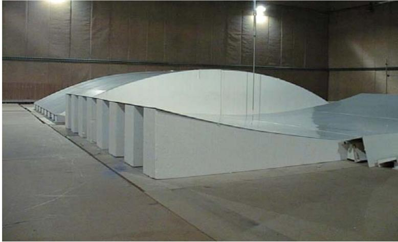
Figure 4-1: Vue du sol plan et des deux sols courbes (convexe et concave) du centre des maquettes du CSTB de Grenoble. Les résultats présentés dans ce chapitre correspondent à des mesures effectuées sur le sol plan et sur la première surface courbe (concave).
