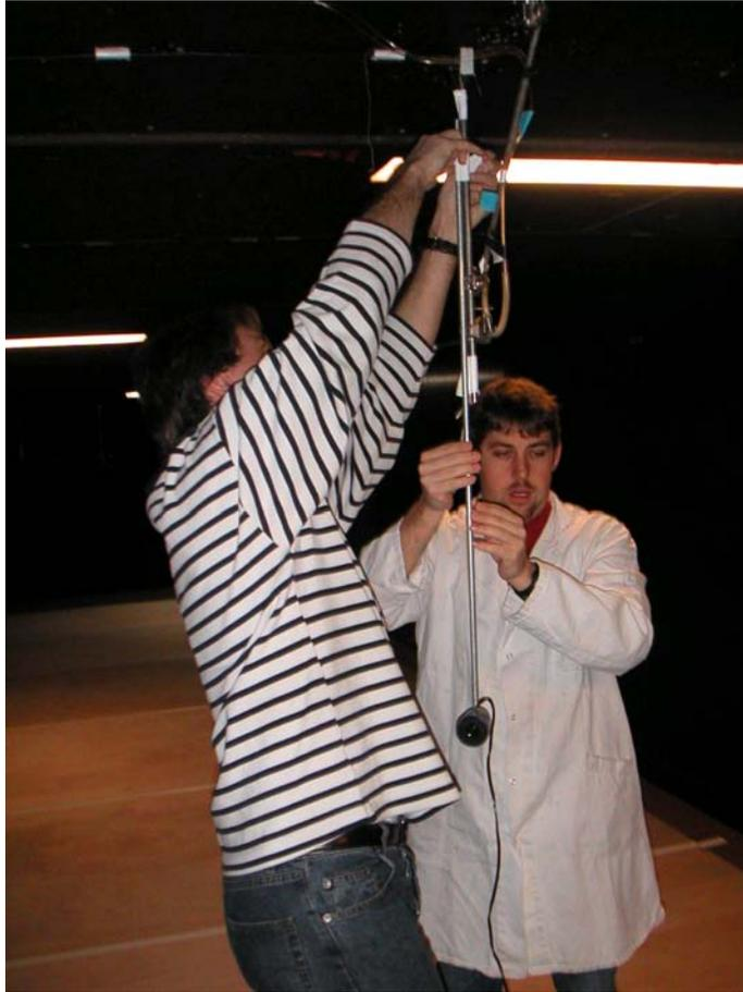
Figure C-7: Photographie prise lors de l'installation du tweeter avant la réalisation de la mesure dite "champ libre". Le tweeter est positionné le plus loin possible des parois. La réponse en champ libre est obtenue après un filtrage temporel adapté du signal enregistré.
