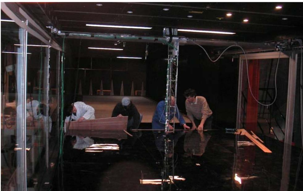
Figure C-8: Photographie prise lors de la mise en place du remblai. La partie mobile du plancher (en premier plan) est sur-élevée à l'aide d'un système de vérin.
