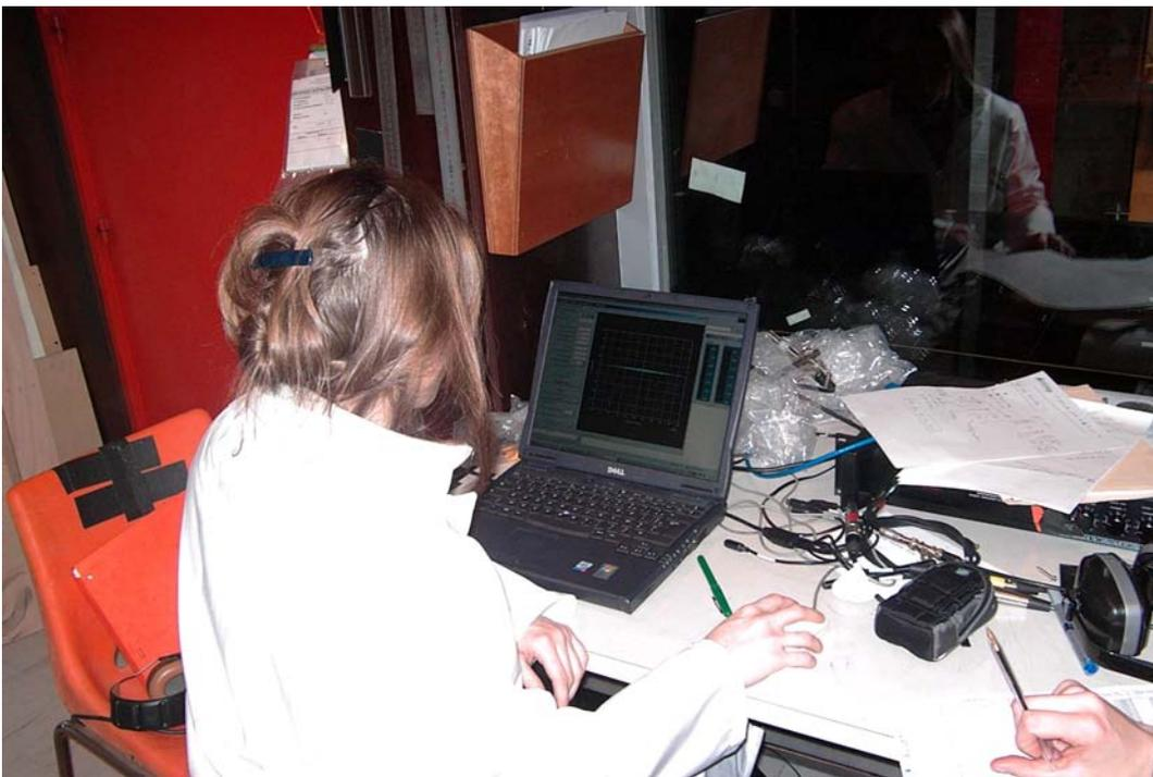
Figure C-4: Photographie du poste d'acquisition des signaux acoustique. Ceux-ci sont enregistrés sur un ordinateur portable PC à l'aide du logiciel IREstimate (Logiciel CSTB) par l'intermédiaire d'une carte d'acquisition VXPocket.
