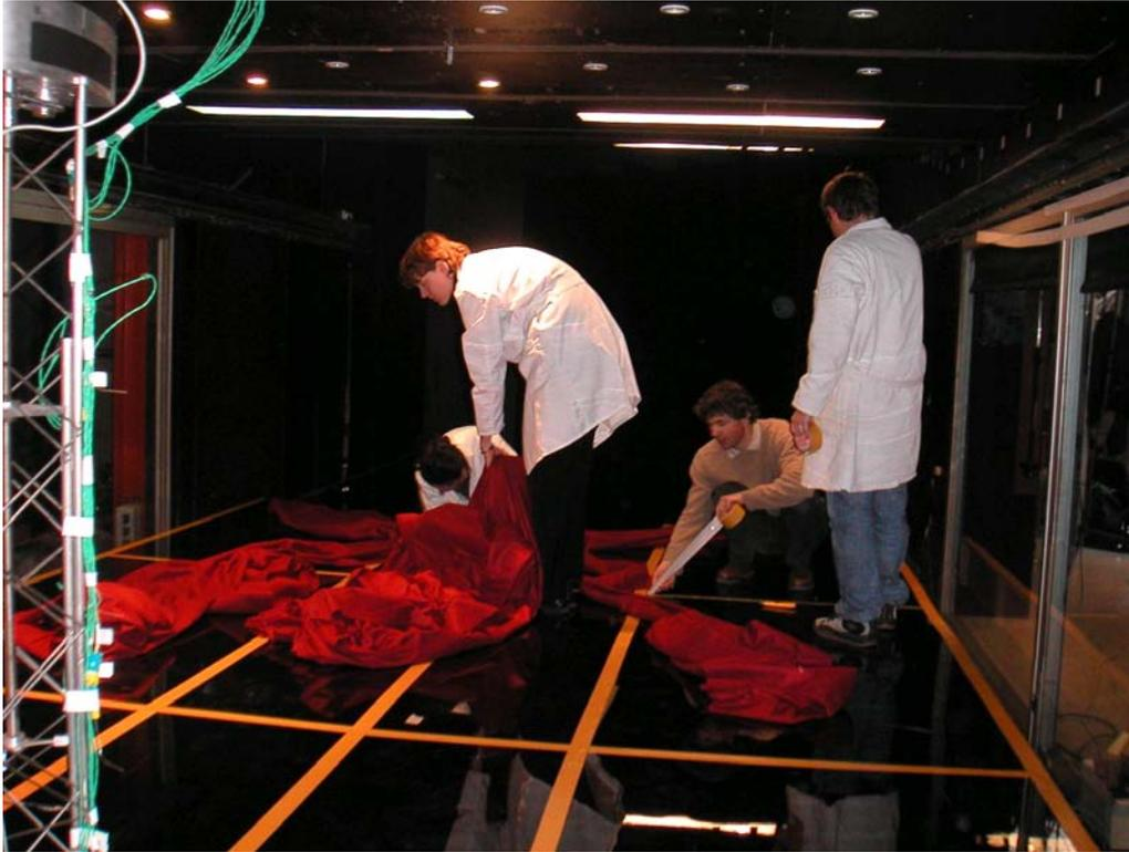
*Figure C-9: Photographie prise lors de la mise en place de la feutrine servant à simuler un sol absorbant.*
