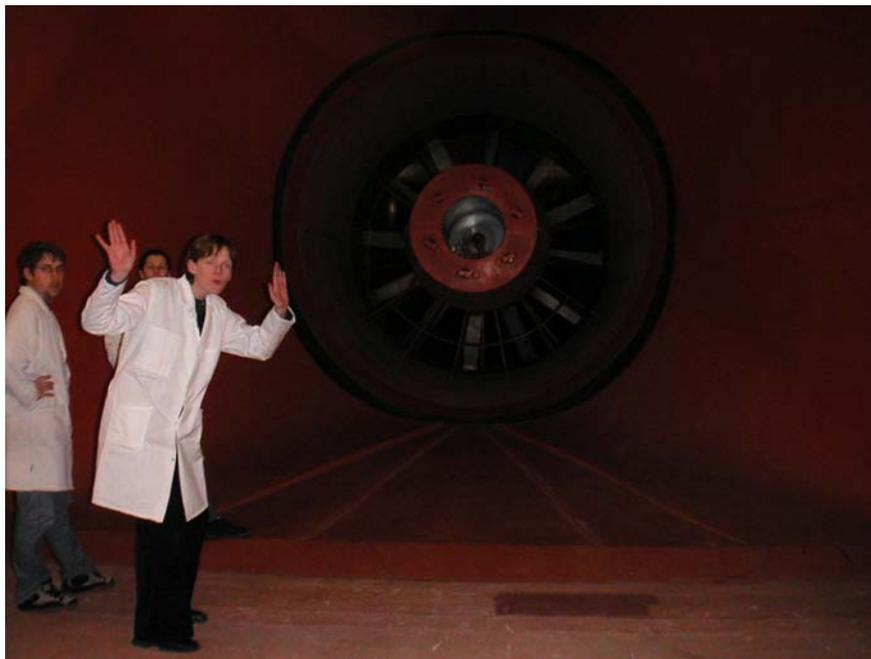
*Figure C-2: Photographie de la turbine de la soufflerie. Les douzes pales à inclinaison variable permettent de régler la vitesse et le sens du vent.*
