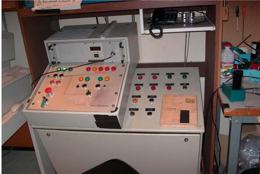
*Figure C-1: Photographie de la console permettant le contrôle de la turbine de la soufflerie. Elle est utilisée pour faire varier la direction et la vitesse du vent.*
