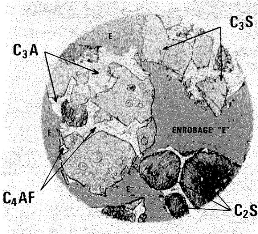
Fig. 2. Coupe de grains de ciment enrobés dans une résine. Agrandissement 400 X (photo Furlan).
