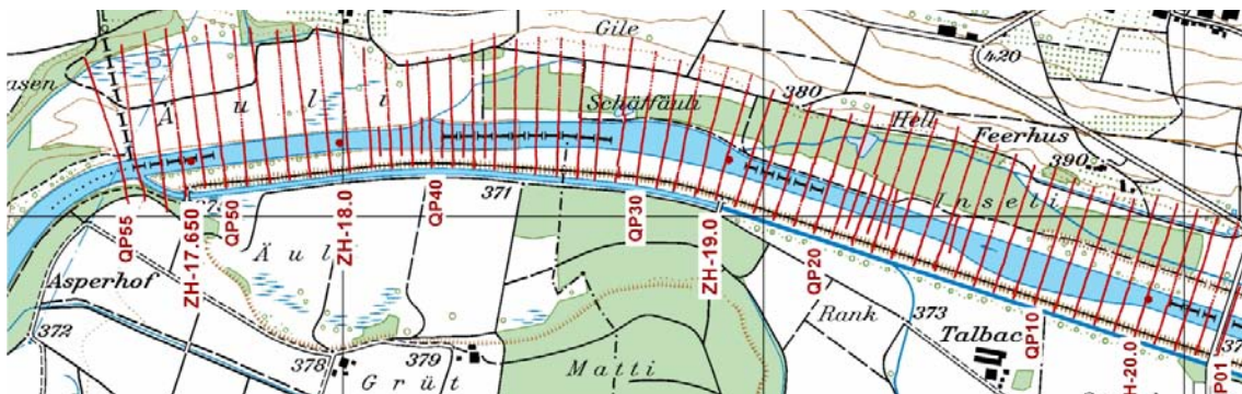
Abb. 2: Topographisches Monitoring der Aufweitung bei Altikon. Die Entwicklung des Gerinnes wird mit Querprofilen mit grosser räumlicher (max. Abstand 50m) und zeitlicher Auflösung aufgenommen.
