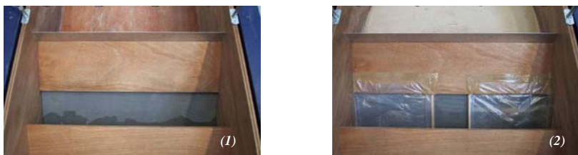
Figure 4: Introduction d'eau dans le fusible (vue d'amont) : (1) sur toute la largeur, (2) centrée sur la gaine
