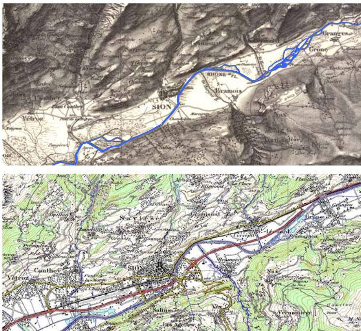
Figure 1 : Le lit du Rhône à Sion. En haut, avant la 1 ère correction (carte Dufour de 1848). En bas, le tracé actuel après la 2 ème correction
