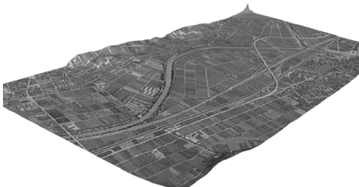
Figure 12: Orthophotographie plaquée sur le volume de synthèse de la zone simulée (sans distorsion d'échelle)
