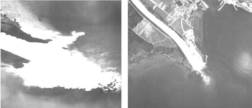
Figure 2.10: Images d'un courant de turbidité plongeant dans un lac. Le Rhône à son embouchure dans le Léman
