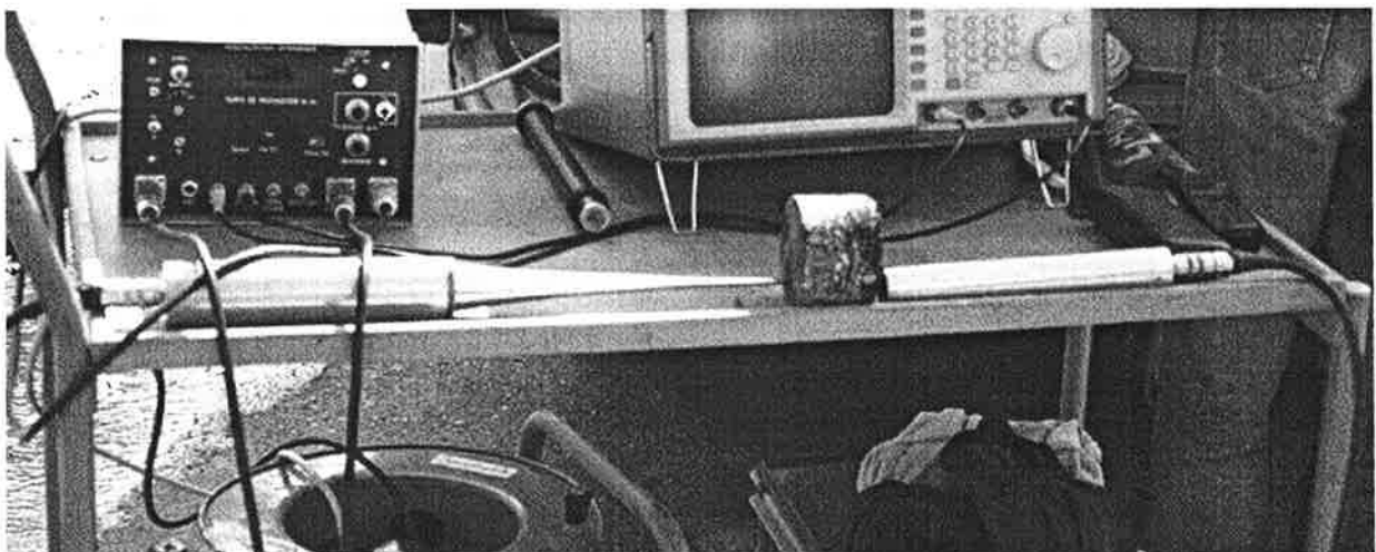
Bild 17 - Ermittlung der Wellenausbreitungsgeschwindigkeit am Bohrkern mit Ultraschall
