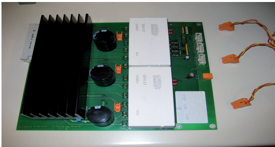
FIG. 7.10: Photo de la carte de puissance
