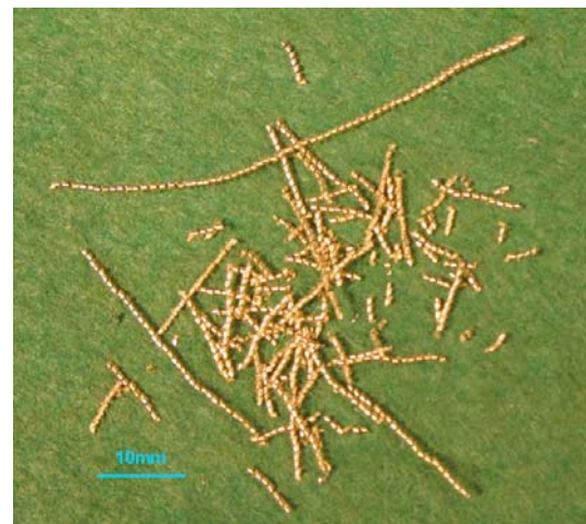
Figure 3. Copeaux obtenus après tournage des fils de laitons obtenus dans des conditions de coupe identiques.
