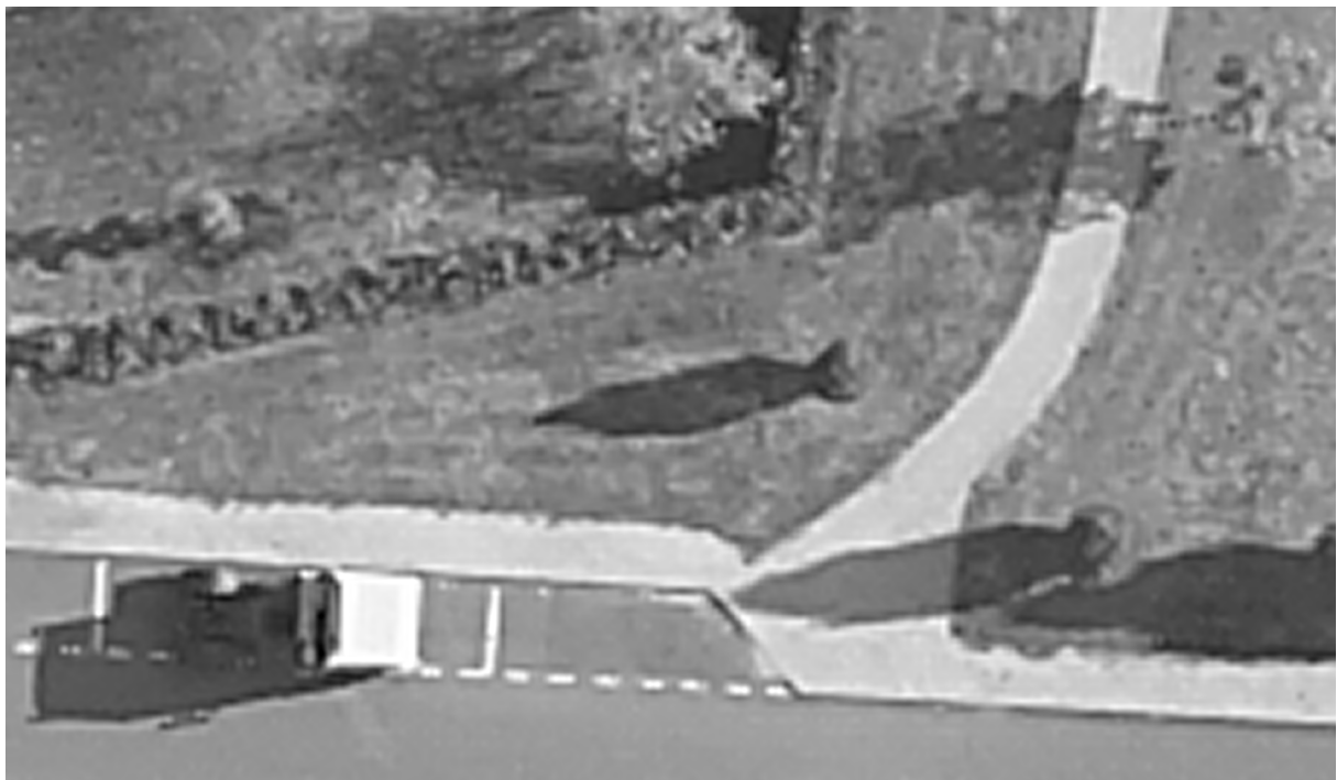
Abbildung 11: Effekte der Kantenverstärkung bei Aufnahmen mit der Rolleikammer; man beachte den dunklen Rand der Schatten und den anschließenden hellen Streifen, Größe des Bildausschnitts 229x134 Pixel.
