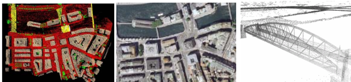
Figure 1 – Quelques exemples de sources de données disponibles dans la ville de Genève. De gauche à droite : points bruts obtenus par LIDAR aéroporté (classés en fonction de la couverture du sol) ; orthophoto ; modèle brut obtenu par LIDAR terrestre (résolution à 25 cm) d'un pont (passerelle de l'île).
