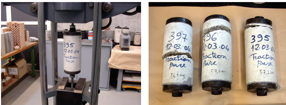
Figure B-2.9: Essai de traction à 32 jours (G1) et éprouvettes après rupture
