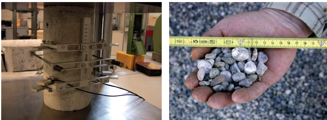
Figure B-2.8: Instrumentation de cylindre à la compression (32 jours G1), et dimension maximale de l'agrégat, d_g=16 mm
