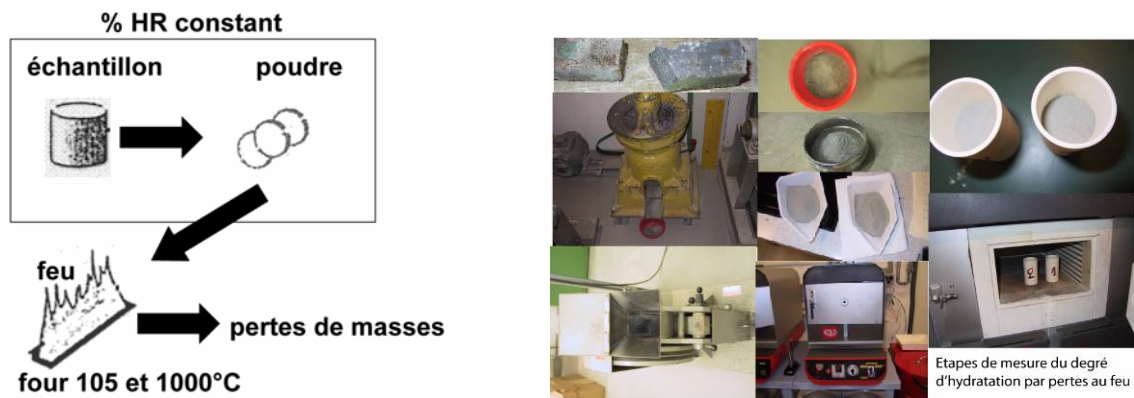
Figure 14: Etapes de mesure du degré d'hydratation par perte au feu
