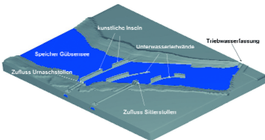
Bild 6: Modell des Speichers mit den vorgeschlagenen Unterwasserleitwänden und den fünf künstlichen Inseln, sichtbar gemacht dank abgesenktem Seespiegel ein Meter unter der Oberkante der Holzpalisadenwände.
