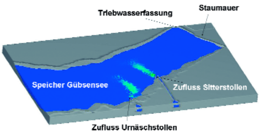
Bild 2: Modell mit den Hauptelementen des Speichers Gübsensee.
