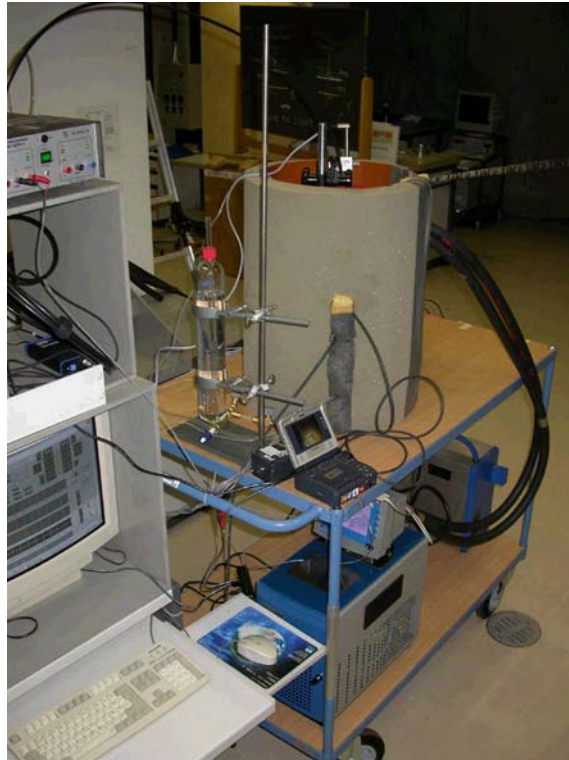
4-4 Cellule avec son isolation extérieure et une partie de la chaîne de mesure
