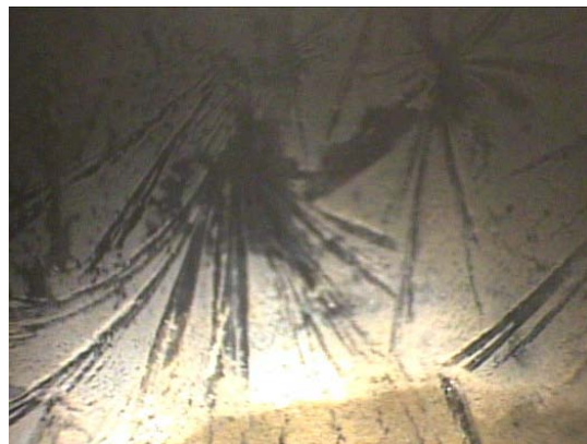
5-15 Essai no 3: Aiguilles de glace juste sous la tête de refroidissement
