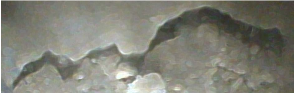
5-31 Essai no 4: Trou laissé par une lentille fondue Hauteur de l'image = env. 1,5 mm
