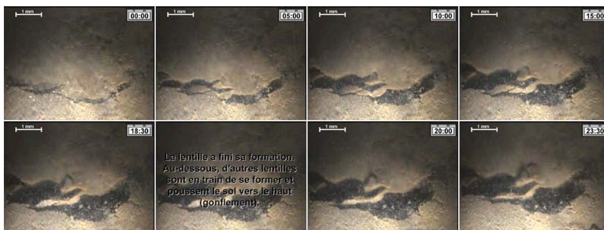
5-9 Essai no 3 : Formation d'une lentille de glace, h=185 mm, 0 h = 308 h de tout l'essai (fig. 5-8) Séquence d'images tirée d'une animation
