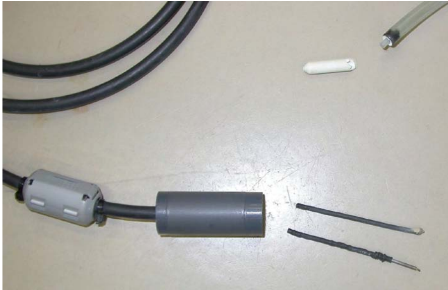
4-36 Dégâts sur un tensiomètre et un capteur TDR
