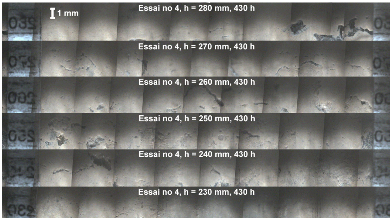
5-29 Essai no 4: Panoramas 360° à différentes profondeurs, 430 heures après début essai (vers fin rampe dégel)
