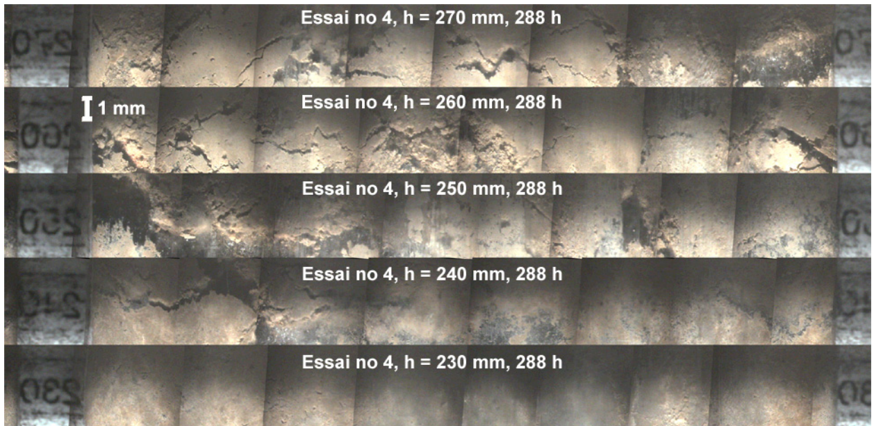
5-28 Essai no 4: Panoramas 360° à différentes profondeurs, 288 heures après début essai (début rampe dégel)
