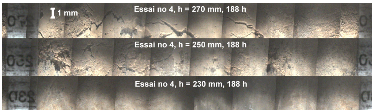
5-27 Essai no 4: Panoramas 360° à différentes profondeurs, 188 heures après début essai (milieu gel)
