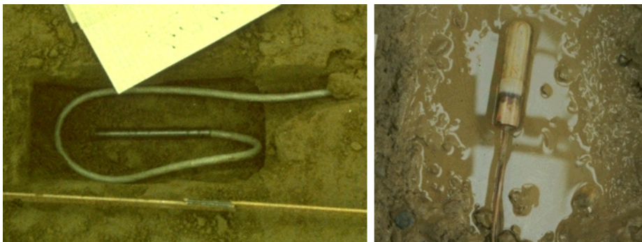
9-2 Thermomètre Pt 100 et tensiomètre (remote, 2 tubes)
