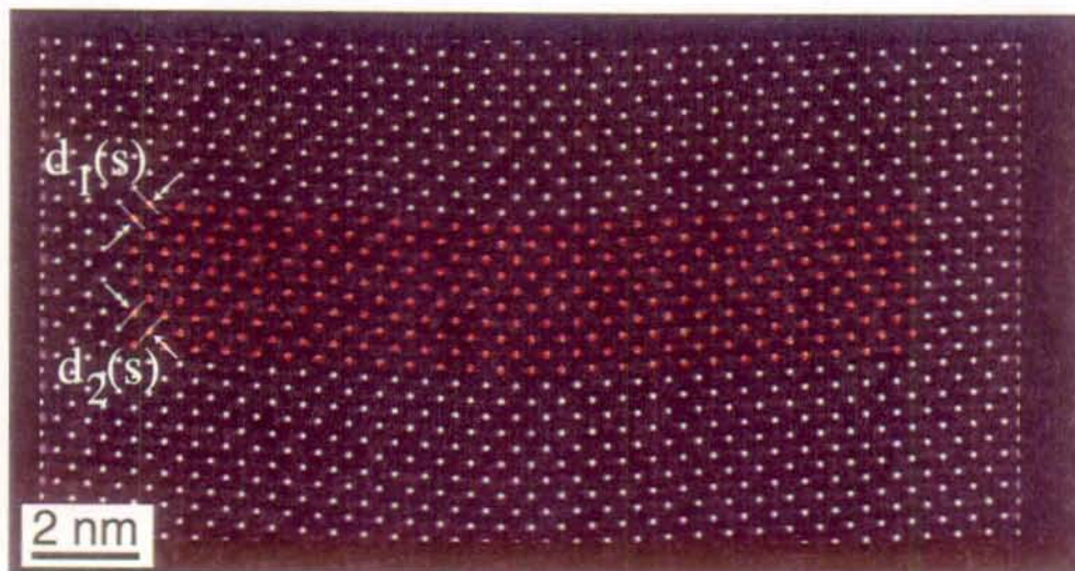
FIG. 7.2 – Exemple d'une image HRTEM simulée d'une paroi de domaines à 90^\circ dans le \text{PbTiO}_3 sur laquelle la routine a été testée. Les petites croix rouges indiquent les centres des taches utilisés pour la mesure des paramètres de maille locaux d_1(s) et d_2(s) .
