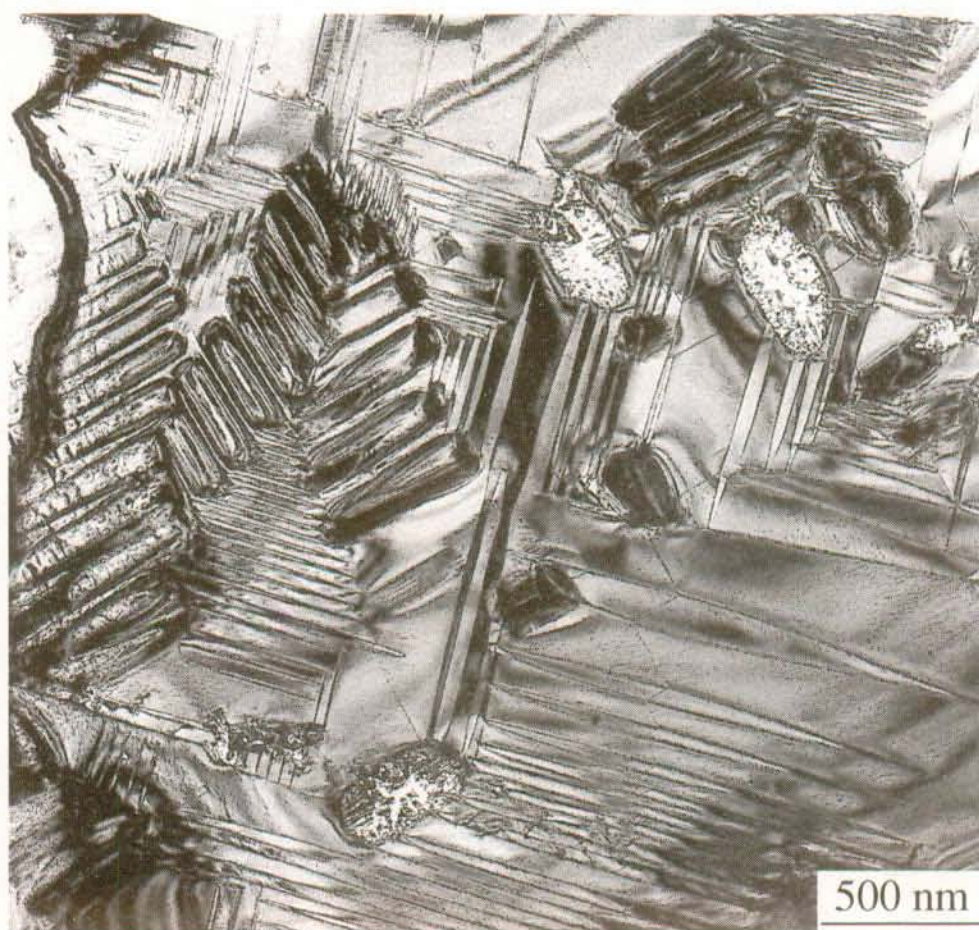
FIG. 8.12 – Cliché en champ clair de la configuration des domaines dans un échantillon ayant subi un cycle de chauffage au delà de la température de transition. Les "trous" correspondent à des régions où la structure du cristal s'est décomposée à cause d'une température trop élevée.
