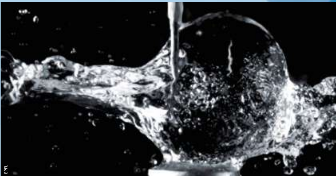
Lors de la cavitation, des bulles se forment sous l'effet des changements de pression, bulles qui implosent. Ce phénomène provoque, par exemple, une érosion des turbines hydrauliques et des hélices de bateau (à gauche). Les images en noir et blanc montrent la cavitation en apesanteur : des gouttes d'eau sphériques. A l'intérieur implose une bulle (tout en haut) et deux jets se développent (ci-dessus).
