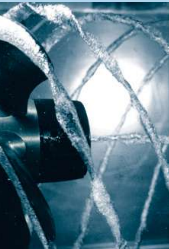
Lors de la cavitation, des bulles se forment sous l'effet des changements de pression, bulles qui implosent. Ce phénomène provoque, par exemple, une érosion des turbines hydrauliques et des hélices de bateau (à gauche). Les images en noir et blanc montrent la cavitation en apesanteur : des gouttes d'eau sphériques. A l'intérieur implose une bulle (tout en haut) et deux jets se développent (ci-dessus).
