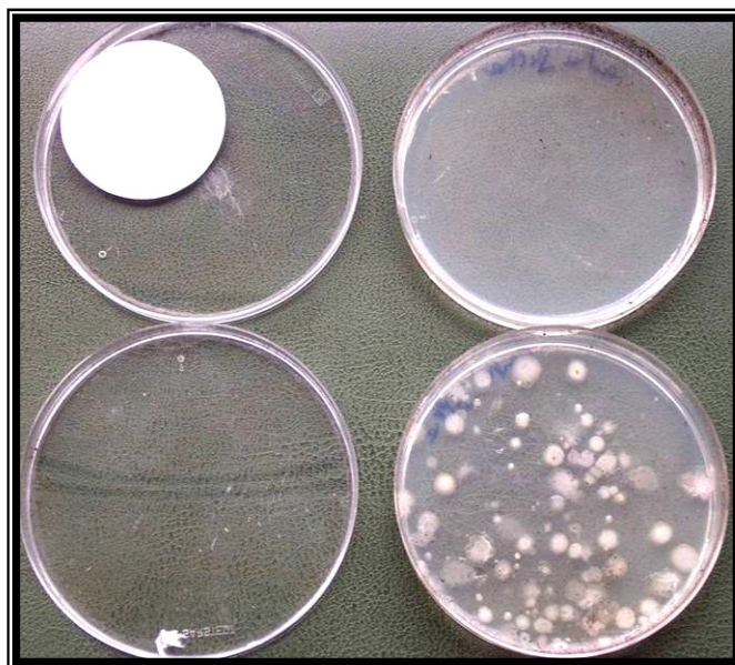
Photo 5 : Effets qualitatifs de la phase volatile d'une huile essentielle de Bois de Rose sur un prélèvement effectué dans une installation de ventilation : (haut) essai en présence d'huile essentielle, (bas) essai témoin
