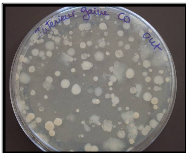
Photo 4 : Prélèvement effectué à l'intérieur d'une gaine de ventilation par application de la gélose à sa surface
