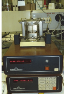
Figure 12-1 : Dispositif pour détermination du point de ramollissement Anneau et Bille
