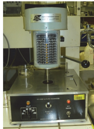
Figure 12-2 : Viscosimètre cône et plaque (gauche : (Dumont 2003))
