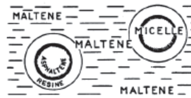
Figure 2-2 : Etat colloïdal des bitumes (Dumont 2003)
