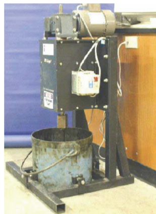
Figure 4-26 : Appareil de mesure de maniabilité (Gudimettla et Cooley 2003)
