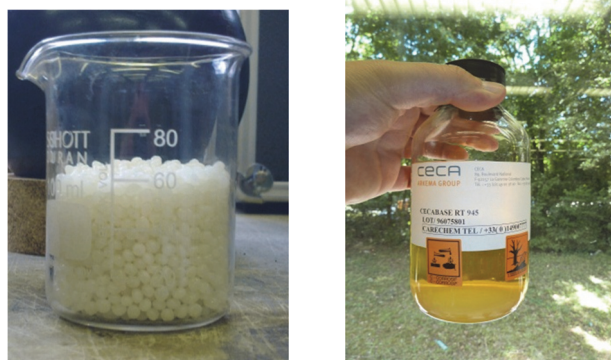
Figure 4-2 : Cire pour additif ET-C (gauche) et additif chimique ET-P (droite)
