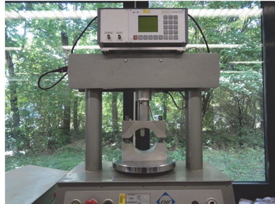
Figure 12-5 : Presse pour essai Marshall (Schéma :(Dumont 2003))
