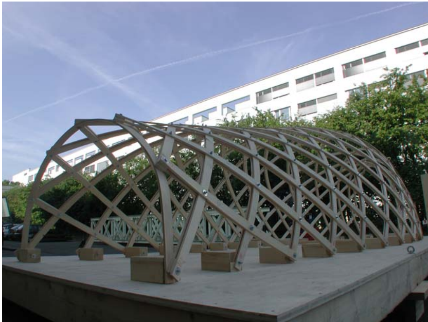
Abbildung 2: Versuchsschale in Brettrippenbauweise
