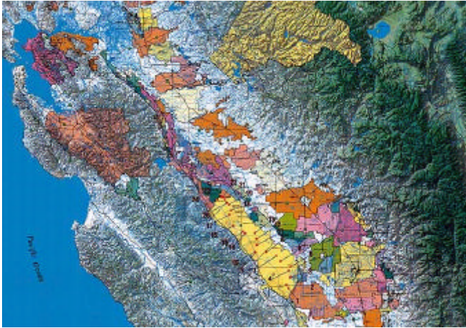
Figure 10.4 : Exemple d'utilisation d'un système d'information géographique en hydrologie. Cette carte affiche les zones de distribution d'eau dans la vallée San Joaquin en Californie. Elle a été produite à l'aide du logiciel ARC/INFO par le US Bureau of Reclamation-MPGIS, Sacramento, California.
