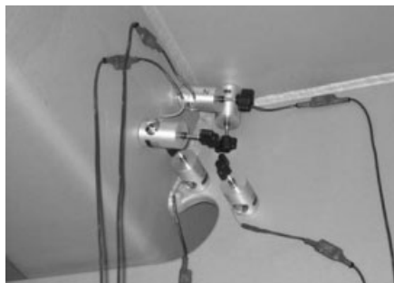
Bild 9. Reibungsmessstreifen an der orthotropen Platte
